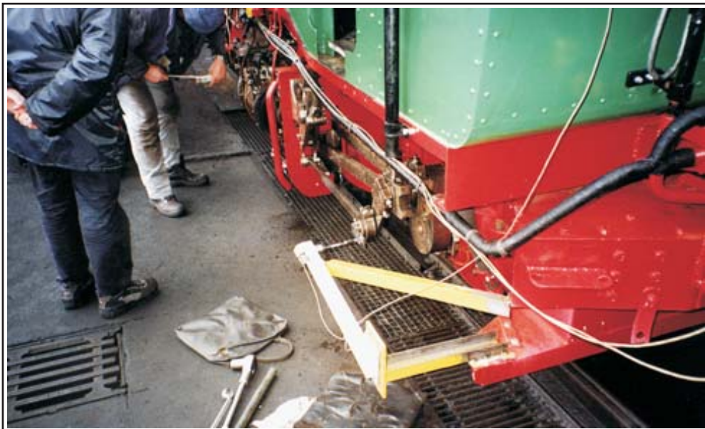
Das Indiziergerät der SDG wird montiert und bringt Klarheit über die Druckverhältnisse in den Zylindern.
