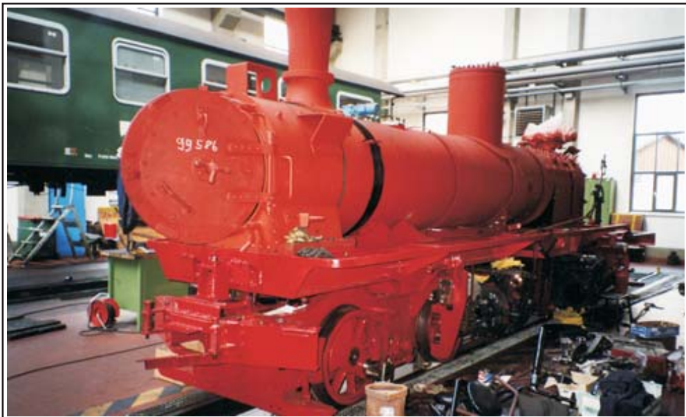
Der aufgearbeitete Kessel hat sein Fahrwerk wieder.
